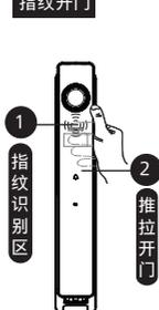
① 将已经添加指纹的手指以正确的方式放在把手内侧的指纹传感器上；
