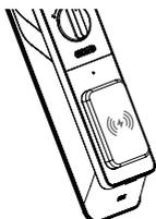
将5V/2A磁吸式无线充电宝放在门锁无线充电区域，可给门锁电池进行充电。
